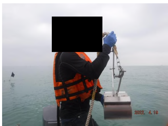
รูปที่ 3-94 การเก็บตัวอย่างสัตว์หน้าดิน (Benthos) ด้วย Petersen Grab Sampler
